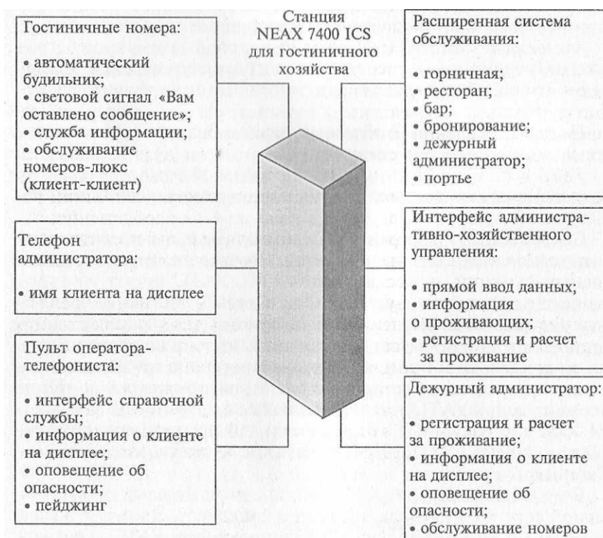
Рис. 2.31. Структурная схема приложения для гостиницы на примере станции Millenium NEAX 7400 ICS
